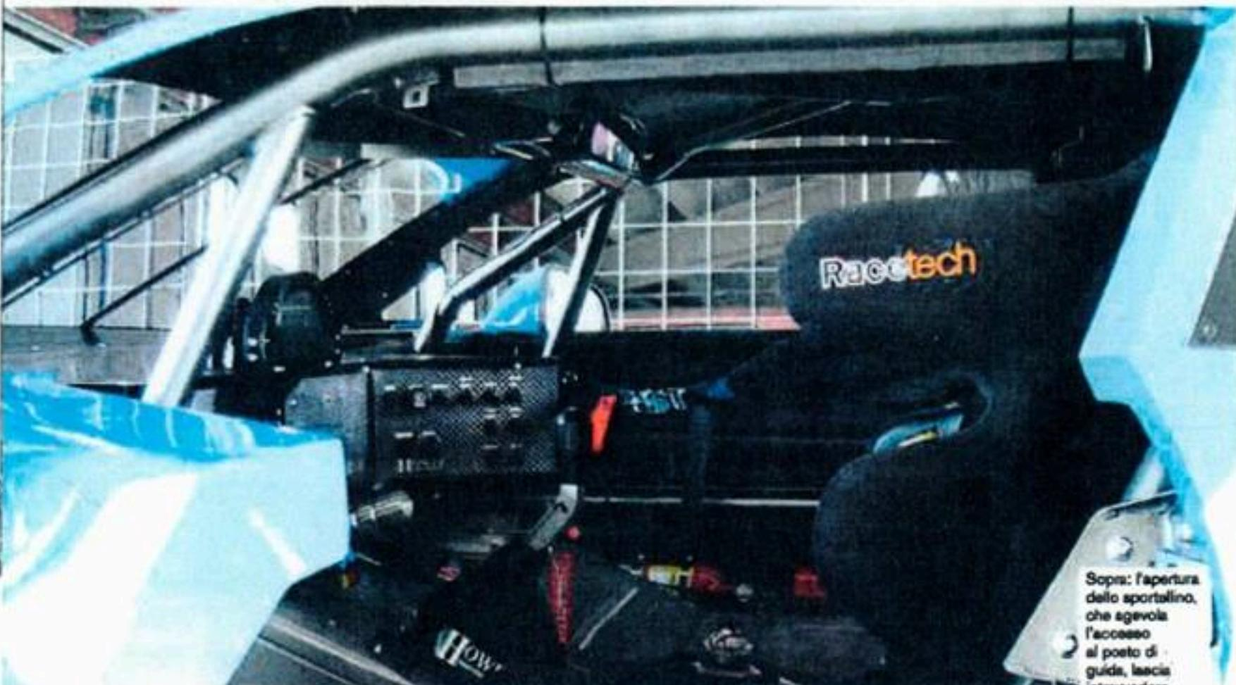
Sopra: l'apertura dello sportellino, che agevola l'accesso al posto di guida, lascia intravedere l'abitacolo essenziale; si nota il piantone dello sterzo, con volante estraibile, il dashboard, la plancia, la leva del cambio e la gabbia di sicurezza. In alto: lo staff di Euro Racing, con il tester e testimonial Eric Van De Poele (col cappello), e il referente per l'Italia Mario Gatto (maglia bianca).
